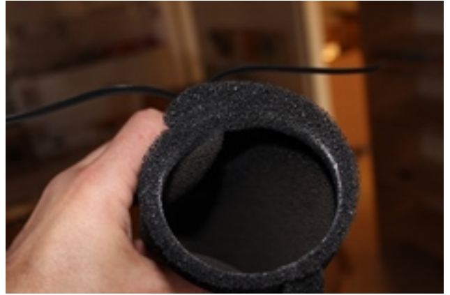
Mycket smutsigt filter från tilluftsventil i Personalmat- o dagrum
